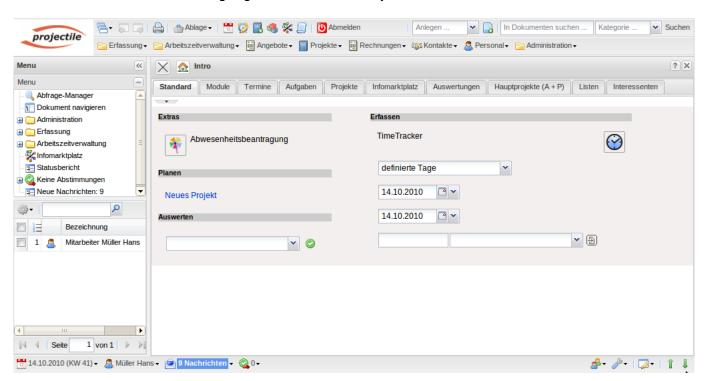
Die obere Navigationsleiste besteht aus einer oberen Menüleiste, der "Blättern"-Funktionalität, einer Toolbar, einer Suchmaschine und der "Home-Funktionalität" (Projectile-Logo).
