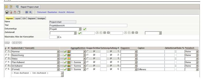
In der Spalte Diagramm müssen für eine 2-dimensionale Auswertung mit x- und y-Achse die Achsen bestimmt werden. Mit Index (x) wird die x-Achse (waagerecht) bestimmt und mit Daten (y) werden die Werte für die y-Achse (senkrecht) gekennzeichnet. Im Beispiel sollen für die Projekte (Nummer) die Werte Plan-Aufwand, Ist-Aufwand und die Differenz (Formel) abgetragen werden.
